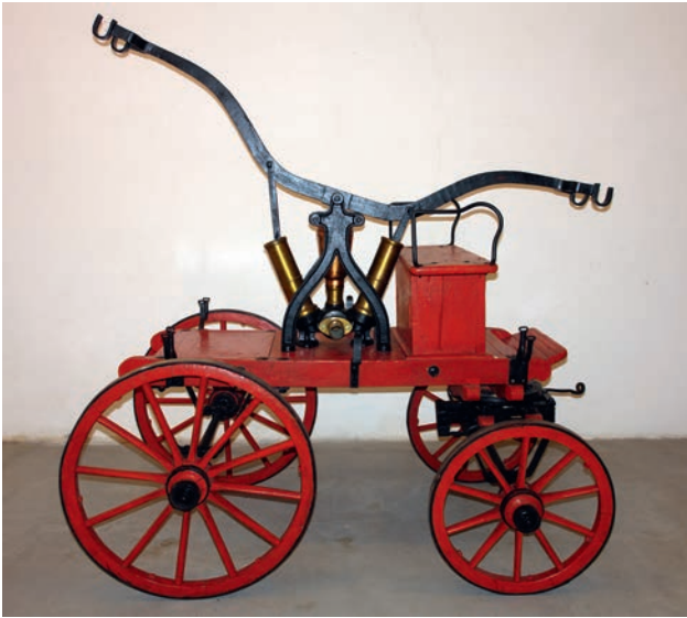
Sikawka czterokołowa konna bez skrzyni wodnej, pocz. XX w., OSP Tryńcza, fot. G. Sznaj, MP-P-650
