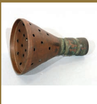
Smok bezzaworowy do sikawki ręcznej, Austro-Węgry, przełom XIX i XX w., fot. G. Sznaj, MP-P-314
