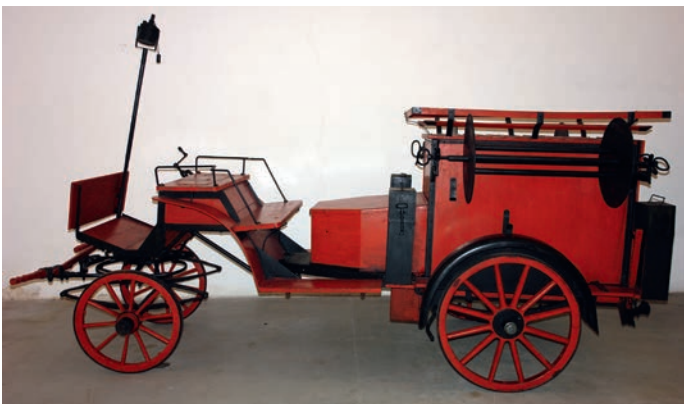
Rekwizytowy wóz konny do przewozu motopompy, węży pożarniczych i armatury wodnej, W. Dittmann-Weimar, Niemcy, 1923 r., OSP Przeworsk, fot. G. Sznaj, MP-P-646
