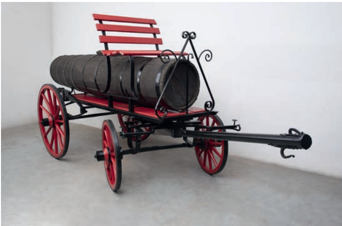
Drewniana beczka na ok. 500 l wody z 1922 r. zamontowana na wozie do zaprzęgu konnego z XX w., fot. H. Górecki, MP-P-897, MP-P-1383
