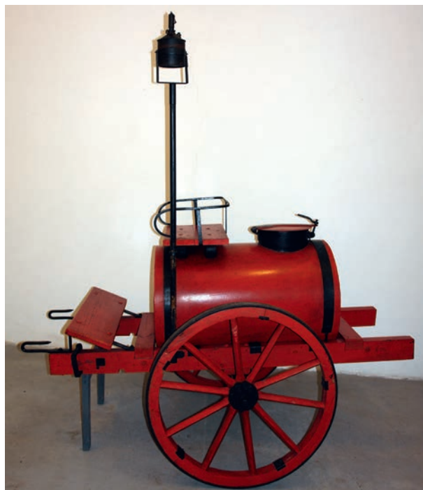
Beczkwóz dwukołowy konny na wodę, 1905 r., OSP Nowosielce, fot. G. Sznaj, MP-P-898
