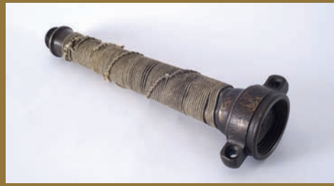
Prądownica zwykła, Polska, 1. poł. XX w., OSP Niżatyce, fot. H. Górecki, MP-P-932
