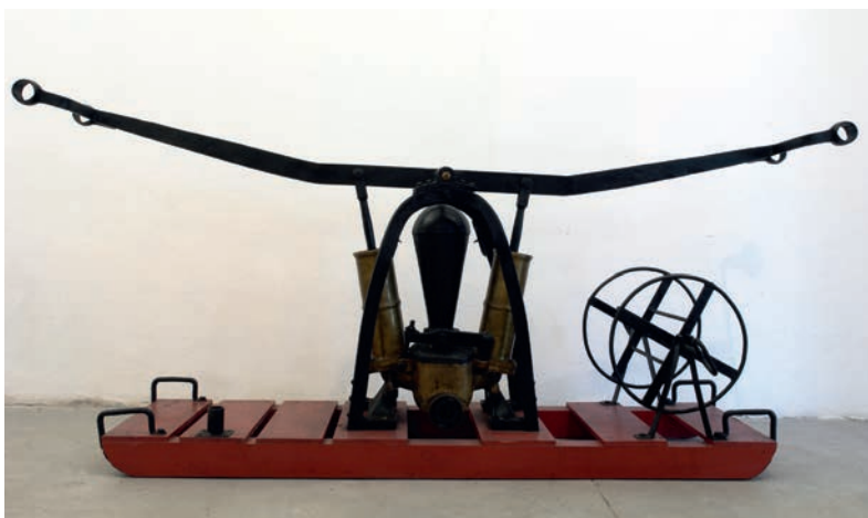
Sikawka przenośna dwucylindrowa bez zbiornika na wodę, Składnica Straży Pożarnych, Warszawa, model produkowany w latach 1921–1939, OSP Jawornik Polski, fot. G. Sznaj, MP-P-658
