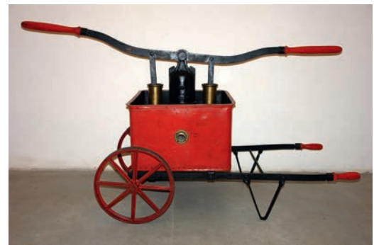
Sikawka kubłowa dwucylindrowa na podwoziu dwukołowym, Wiedeń, przełom XIX i XX w., OSP Sietesz, fot. G. Sznaj, MP-P-651
