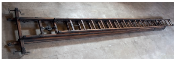
Drabina drążkowa trójprzęstowa wysuwana, Polska, 2. poł. XX w., fot. H. Górecki, MP-P-385
