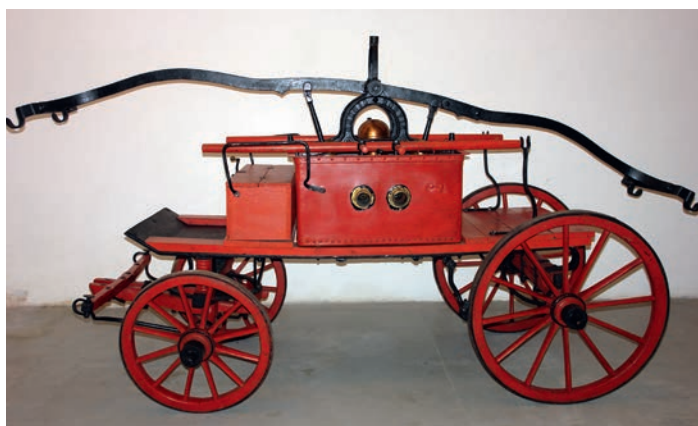
Sikawka czterokołowa konna z górną skrzynią wodną i podwoziem bez resorów, Bracia Bartik, Tarnów, pocz. XX w., OSP Białoboki, fot. G. Sznaj, MP-P-647
