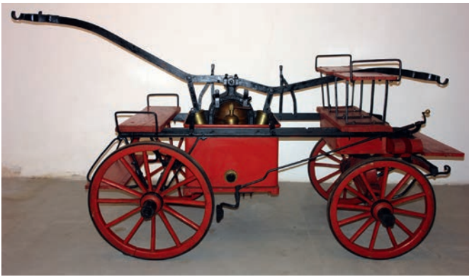
Sikawka czterokołowa konna z dolną skrzynią wodną i podwoziem bez resorów, Unia Strażacka, Lwów, model produkowany w latach 1921–1939, OSP Urzejowice, fot. G. Sznaj, MP-P-655
