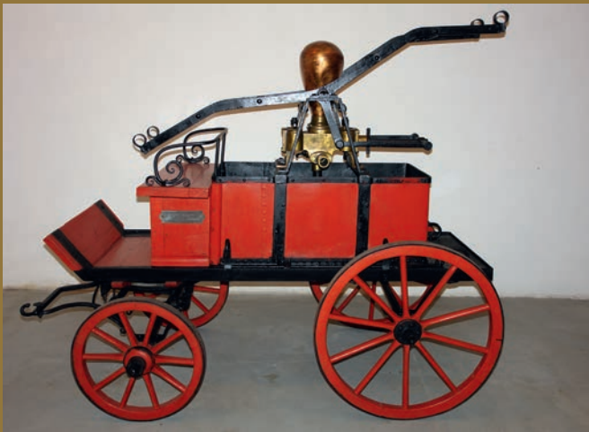
Sikawka czterokołowa konna z górną skrzynią wodną, poziomo umieszczonym cylindrem i podwoziem bez resorów, I. Chylewski, Tarnów, pocz. XX w., OSP Grzęska, fot. G. Sznaj, MP-P-654
