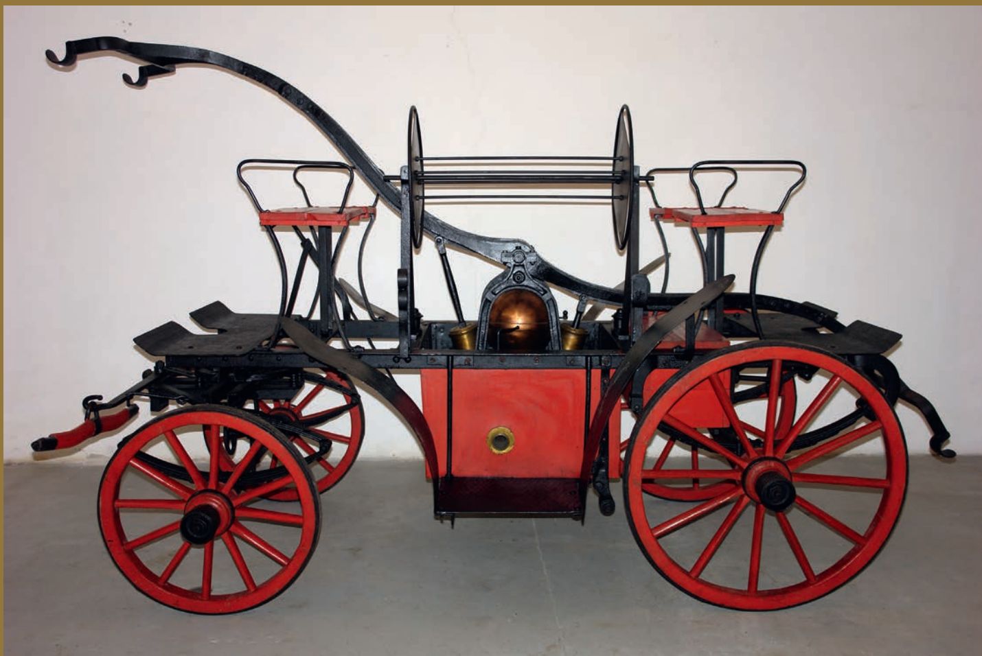
Sikawka czterokołowa konna z dolną skrzynią wodną, podwoziem z resorami i zwijadłem na węże tłoczne, Polska, pocz. XX w., OSP Łopuszka Wielka, fot. G. Sznaj, MP-P-642
