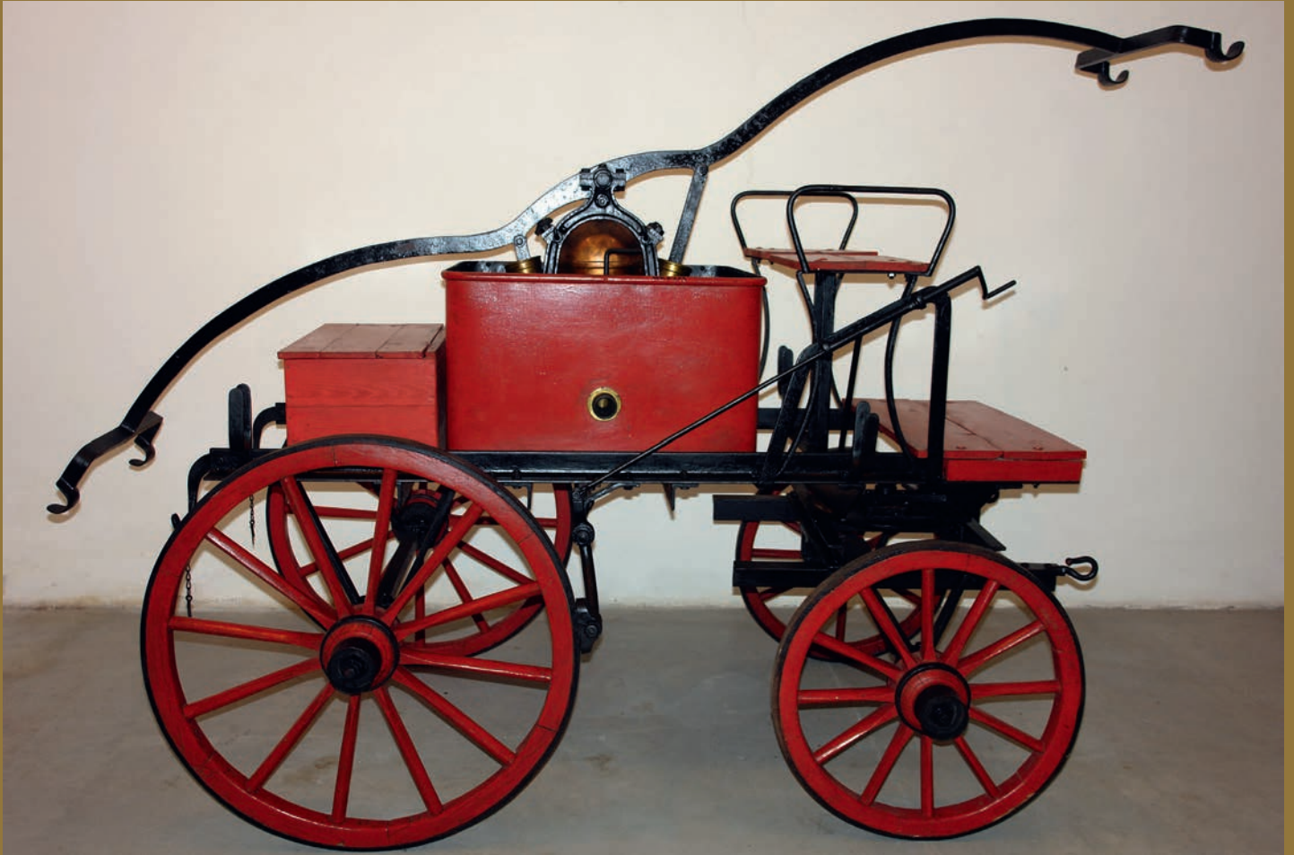
Sikawka konna z górną skrzynią wodną, podwoziem bez resorów, Polska, pocz. XX w., OSP Rozbórz, fot. G. Sznaj, MP-P-653
