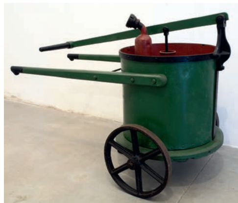
Sikawka kubłowa dwukołowa tzw. „taczkowa”, lata 20. XX w., fot. G. Sznaj, MP-P-618
