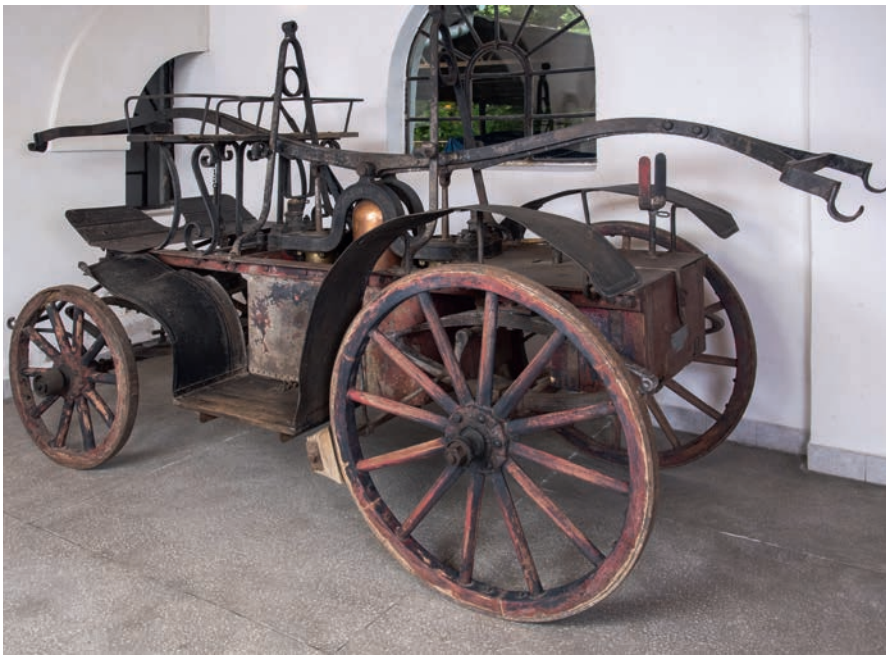
Sikawka czterokołowa konna z dolną skrzynią wodną, Wm. Knaust, Wiedeń, przełom XIX i XX w., fot. H. Górecki, MP-P-1121
