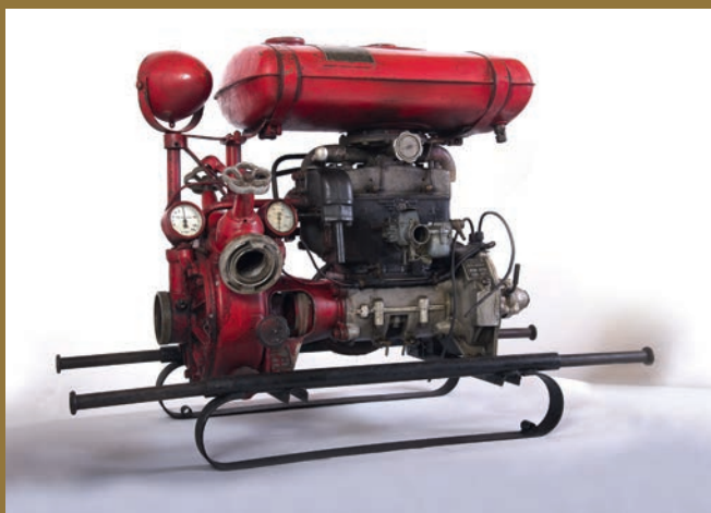
Motopompa strażacka M-800, Typ: Leopolia PO 1, Wytwórnia Sprzętu Mechanicznego Zakład Nr 1, Bielsko, 1956 r., OSP Budy łańcuckie, fot. H. Górecki, MP-P-939 Fire motor pump M-800, Type: Leopolia PO 1, Mechanical Equipment Factory, Plant No. 1, Bielsko, 1956, VFB Budy łańcuckie, photo H. Górecki, MP-P-939
