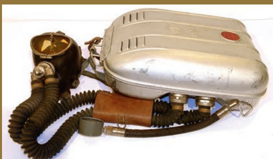
Aparat tlenowy izolujący F.S.R. M-56, Fabryka Sprzętu Ratunkowego, Tarnowskie Góry, fot. G. Sznaj, MP-P-965
