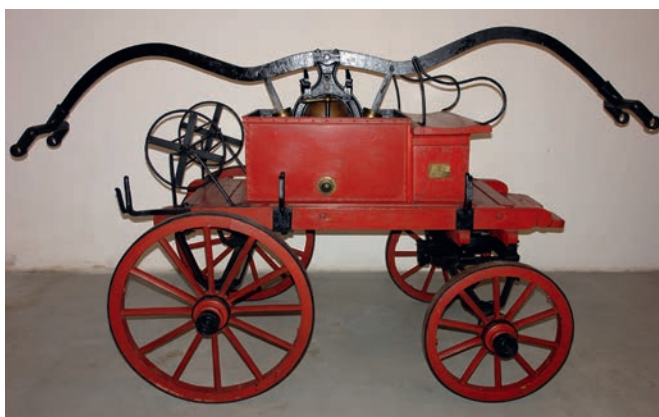
Sikawka czterokołowa z górną skrzynią wodną, podwoziem bez resorów i zwijadłem na węże tłoczne, Pierwsze Galicyjskie Towarzystwo Akcyjne Budowy Wagonów i Maszyn, Sanok, model produkowany do 1915 r., OSP Gać, fot. G. Sznaj, MP-P-648
