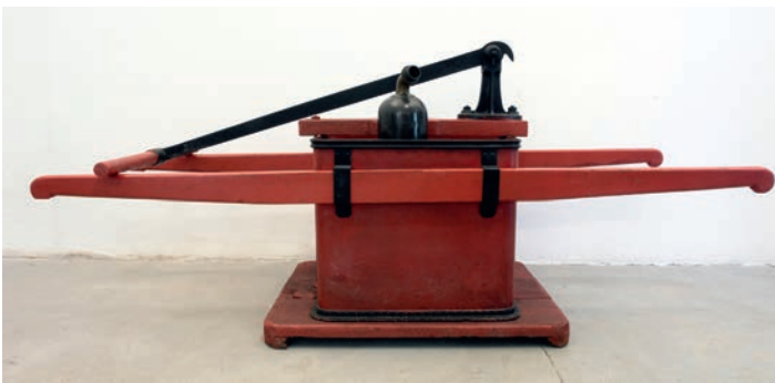
Sikawka przenośna kubłowa, Wm. Knaust, Wiedeń, model produkowany do 1918 r., fot. G. Sznaj, MP-P-368
