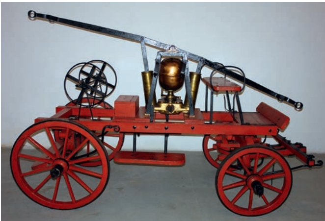
Sikawka czterokołowa konna bez skrzyni wodnej, ze zwijadłem na węże tłoczne, Unia Strażacka, Lwów, nr. fabr.: 55 32, model produkowany w latach 1921–1939, OSP Adamówka, fot. G. Sznaj, MP-P-656
